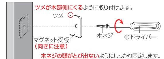
**⚠注意** マグネット受板の向きを間違えますと木ネジの頭が飛び出て、ツメが外向きになり、非常に危険です。必ず、マグネット受板の向きを確認し、正しい向きで取り付けてください。また、マグネット受板のツメはとがっていますのでケガをしない様、取り扱いには十分お気を付けください。
