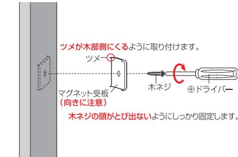
**△注意** マグネット受板の向きを間違えますと木ネジの頭が飛び出て、ツメが外向きになり、非常に危険です。必ず、マグネット受板の向きを確認し、正しい向きで取り付けてください。また、マグネット受板のツメはとがっていますのでケガをしない様、取り扱いには十分お気を付けてください。
