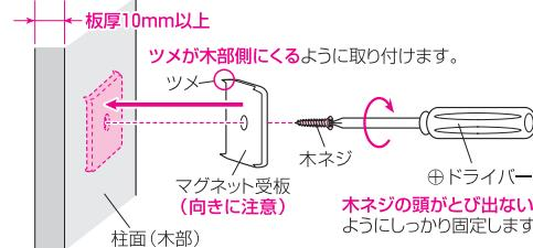
△注意 必ず、マグネット受板の向きを確認し、正しい向きで取り付けてください。(上図参照)
