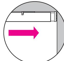
③ キャップ(小)の線が見えなくなるまでレール(小)を強く壁面に押し当てて仮止めする。
