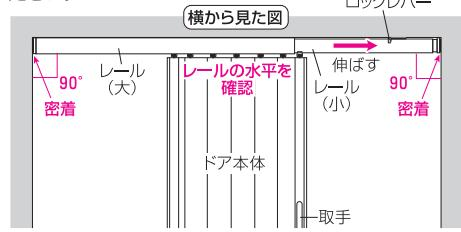
レール(大)にレール(小)を収納した状態(縮めたまま)で、ドアの開く向き(取手は向かって右側)を確認し、ランナーセット棒を全てのランナーの穴に通したまま、ランナーのローラー部分をレールにセットして(入れて)ください。セット完了後、ランナーセット棒を抜き、付属のキャップ(大)をレール(大)に差し込む向き(ツメが穴に掛かる)を確認し、パチンと音がするまで差し込んで固定してください。
