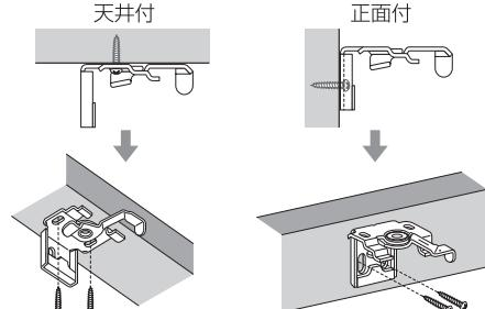
天井付及び正面付のいずれの場合も**木ネジは必ず各2本使用**、しっかりと固定します。
