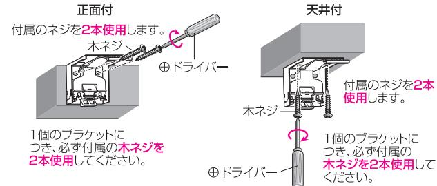
**△注意** 全てのブラケットが直線上で水平に確実に取り付けられているか、再度ご確認ください。
