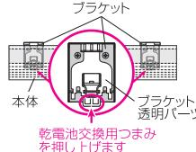
②本体上部が前に倒れますので、乾電池を交換してください
