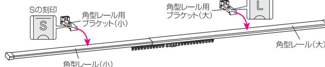
図の様に角型レール用ブラケットへ角型レールをセットし、押し込み小ネジを締めて固定します。
