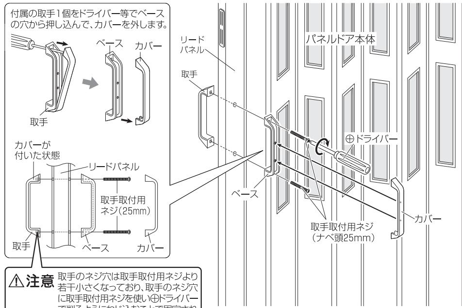
△注意 取手のネジ穴は取手取付用ネジよりも若干小さくなっています。取手のネジ穴に取手取付用ネジを使い、ドライバーで削るようにねじ込むことで固定されます。そのため取手のネジ穴にはネジ山はありません。
