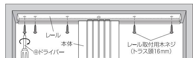
**△注意** レール取付用木ネジの入数は、最大の寸法分の数量ですので取り付け幅に応じてご使用ください。又、レールを固定する時レール取付用木ネジの頭が飛び出さないようにしてください。
