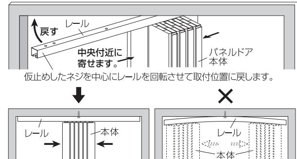
**△注意** 仮止めの状態で、本体を片側に寄せると本体が落下したり、レール破損の原因になりますのでご注意ください。
