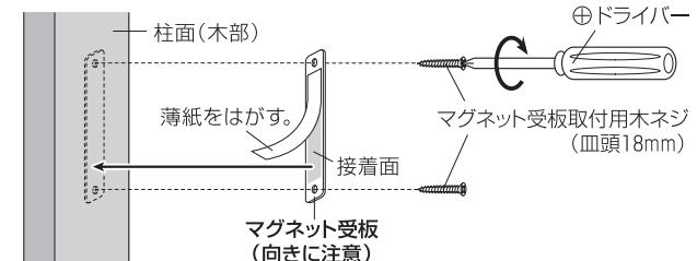
**△注意** マグネット受板を固定する時、マグネット受板取付用木ネジの頭が飛び出さないようにしてください。
