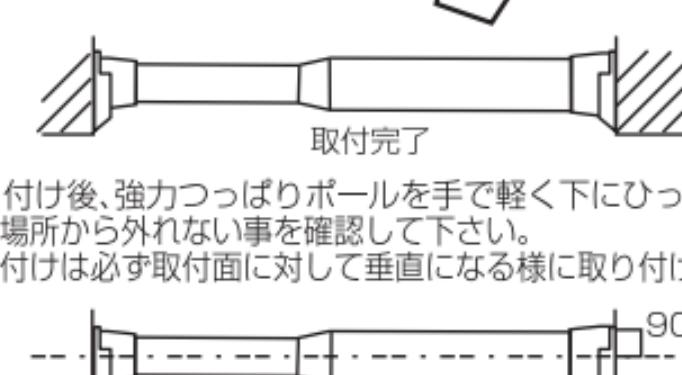
※取り付け後、強力つっぱりポールを手で軽く下にひっぱり、取り付け場所から外れない事を確認して下さい。
