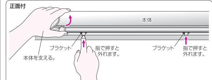
**△注意** 本体をブラケットから外す時は、本体が落下しないように支えた手を離さないでください。ブラケットから外している途中で支えた手を離すと落下、破損の原因になります。本体の取付後は、取り外す時以外、ブラケットのプラスチックの突起部分に触れないでください。触ると本体が外れ、落下の原因になります。
