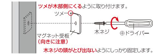
**△注意** マグネット受板の向きを間違えますと木ネジの頭が飛び出で、ツメが外向きになり、非常に危険です。必ず、マグネット受板の向きを確認し、正しい向きで取り付けてください。また、マグネット受板のツメはとがっていますのでケガをしない様、取り扱いには十分お気を付けください。
