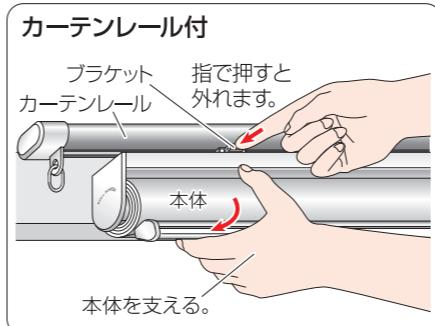
△注意 本体をブラケットから外す時は、本体が落しないように支えた手を離さないでください。ブラケットから外している途中で支えた手を離すと落下、破損の原因になります。本体の取付後は、取り外す時以外、ブラケットのプラスチックの突起部分に触れないでください。触ると本体が外れ、落下の原因になります。
