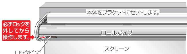
△注意 操作をする前にロックpinのロックが外れている事を必ず確認してください。ロックしたまま無理に操作をしますとプラグホルダーから外れて落下したり、本体破損の原因になります。
