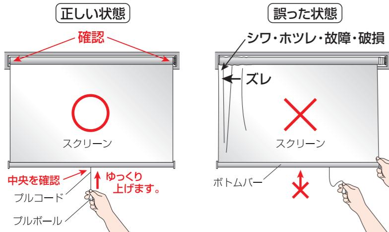
※取付場所が水平でない時やプルコードが中央でない状態又は、ボトムバー等スクリーンを持って操作しますとスクリーンを巻き上げた時、巻きズレが起こりスクリーンにシワやホツレが発生し、本体の故障、破損の原因になる恐れがあります。巻きズレが起きた時は、プルコードが中央にあることを確認した後、必ずプルボールを持ってスクリーンを下げる、ズレを直しながら、ゆっくりと上昇させてください。
