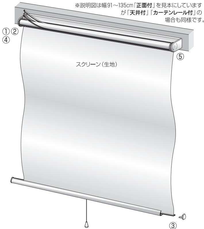
※ロールパイプが空回りしてスクリーンが巻き上がらなくなった場合は、スクリーンを一番下まで降ろした状態からピンプラグホルダー側の巻き上げ調整ダイヤルを巻き上げ方向(速側)に、幅35~59cm: 約10回転、幅60~180cm: 約25回転させてスクリーンを巻き上げた後、巻き上げスピードを調整してください。(「巻き上げスピードの調整方法」参照)
