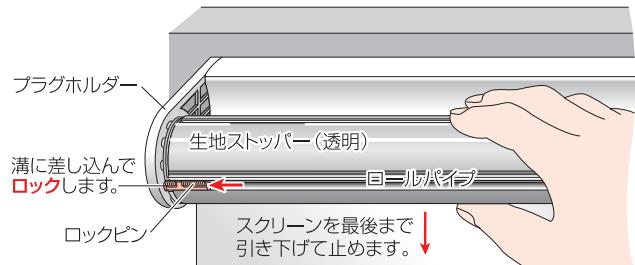
②ロールパイプから生地ストッパー(透明)を全て外した後、スクリーンを外してください。
