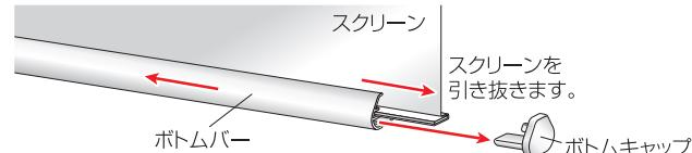
④スクリーンの下部のホッチキス止めされたプレート部分を半周巻き込んでボトムバーに全て差し込んだ後、ボトムキャップを差し込んでください。
