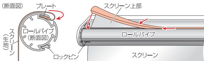
②生地ストッパーのフックの向きを確認し、先にロールパイプのロックピン側の溝部分にはめ込んだ後、スクリーン上部(生地側)を差し込んだ溝に押し込んでください。
