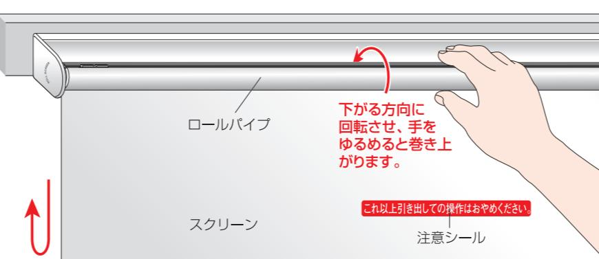
△注意 ストップが解除されると急激に巻き上がり思わぬケガや事故の原因になりますので、ストップの解除が確認されたら必ず止めてプルボールを持って操作してください。
