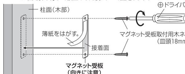
**注意** マグネット受板を固定する時、マグネット受板取付用木ネジの頭が飛び出さないようにしてください。
