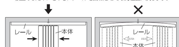
**注意** 仮止めの状態で、本体を片側に寄せると本体が落下したり、レール破損の原因になりますのでご注意ください。
