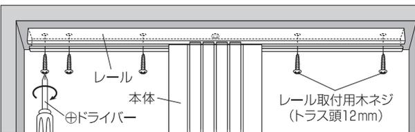
**注意** レール取付用木ネジの入数は、最大の寸法分の数量ですので取り付け幅に応じてご使用ください。又、レールを固定する時レール取付用木ネジの頭が飛び出さないようにしてください。
