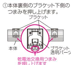
② 本体上部が前に倒れますので、乾電池を交換してください
