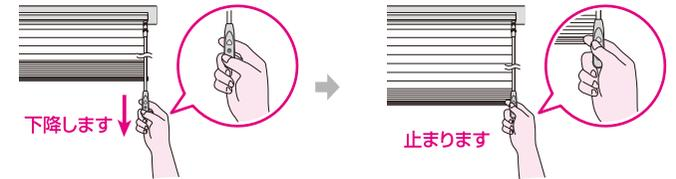
下降ボタンを長押しするとボタンを離しても下降し続けます。上昇ボタンを長押しするとボタンを離しても上昇し続けます。停止ボタンを押すと動作が止まります。
