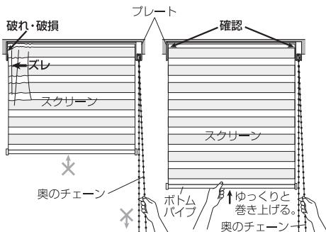
③ 巻き上げ・下げる時に、生地巻きの組合せ関係上、多少生地がずれます。が、チェーンを操作して生地を合わせてください。
