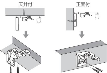
天井付及び正面付のいずれの場合も木ネジは必ず各2本使用し、しっかり固定します。
