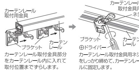
④ カーテンレールに固定されたブラケットにアルミブラインド本体を取り付けてください。(木部に取付ける場合②参照)
