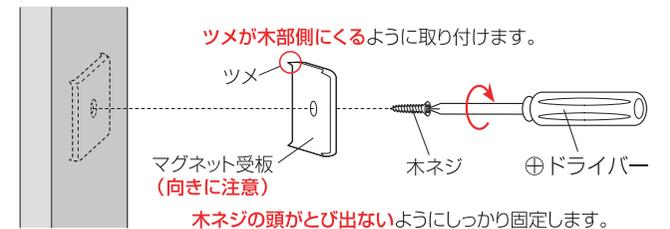
**注意** マグネット受板の向きを間違えますと木ネジの頭が飛び出て、ツメが外向きになり、非常に危険です。必ず、マグネット受板の向きを確認し、正しい向きで取り付けてください。また、マグネット受板のツメはとがっていますのでケガをしない様、取り扱いには十分お気を付けてください。
