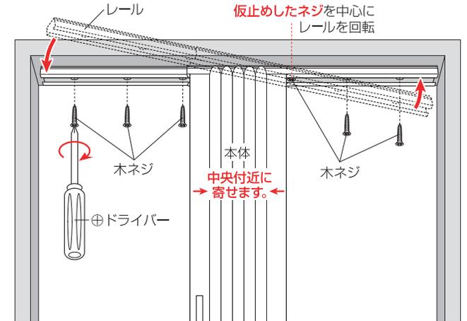
**注意** レールの重なり部分のネジ穴には、木ネジを打たないでください。
