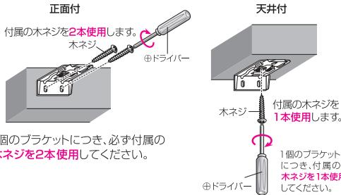
**△注意** 全てのブラケットが直線上で水平に確実に取り付けられているか、再度ご確認ください。
