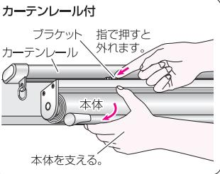
**△注意** 本体をブラケットから外す時は、本体が落下しないように支えた手を離さないでください。ブラケットから外している途中で支えた手を離すと落下、破損の原因になります。本体の取付後は、取り外す時以外、ブラケットのプラスチックの突起部分に触れないでください。触ると本体が外れ、落下の原因になります。
